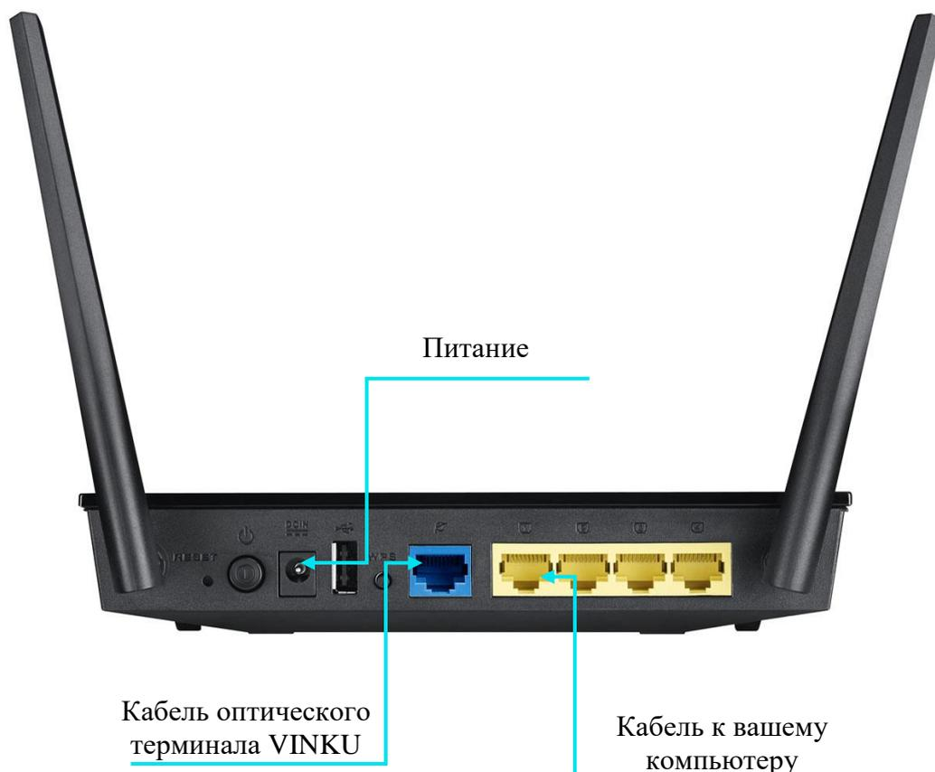
1.1 Подключите кабель от оптического терминала VINKU в разъем синего цвета, обозначенный надписью «**Интернет**».
